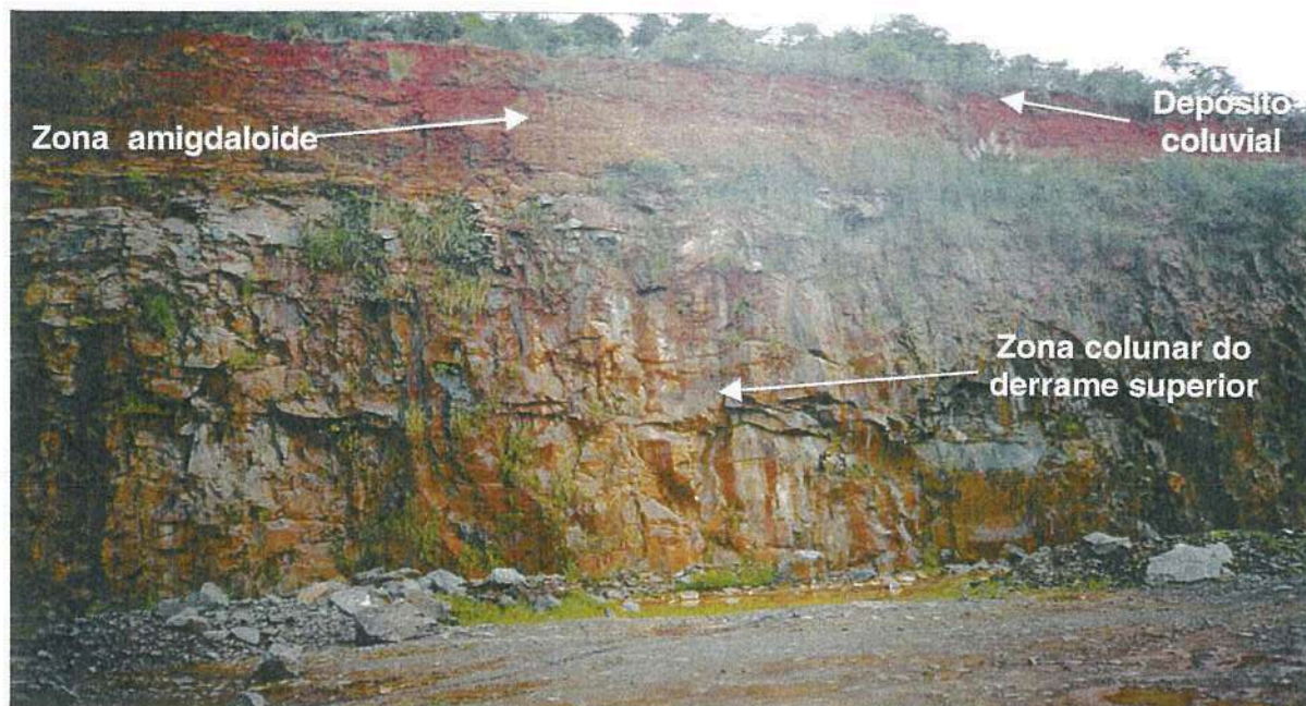
Fig. 10.5 Derrame basáltico superior observado na Pedreira Baldissera, onde a zona amigdalóide está totalmente alterada à solo, com coloração avermelhada. Segue a zona colunar do derrame superior, formada por basalto equigranular fino, cinza escuro, maciço, com fraturamento espaçado de 10 a 80 cm.
